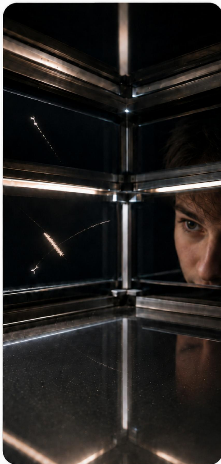
Wnętrze komory mgłowej – tu niewidzialne promieniowanie zostawia widoczne ślady cząstek.
